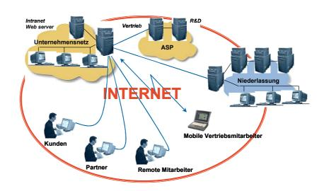
Technologien, die sichere Kommunikation über unsichere Netzwerke erlauben. **VPN** setzt IPSec-Tunnel sogenannte zwischen zwei Gateways ein um private Daten zwischen unsicheren Netzwerken sowie das Internet zu schützen
